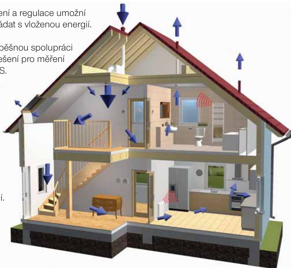
Schéma řízeného přetlakového větrání.
